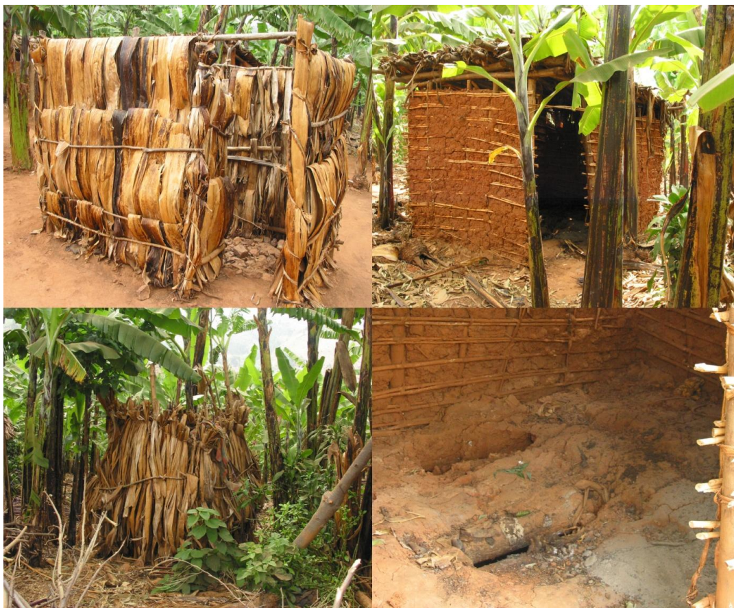
Fot.3,4,5 i 6 Przykłady latryn używanych w Afryce Południowo-Wschodniej. Budowane są one z prostych i łatwo dostępnych materiałów.
