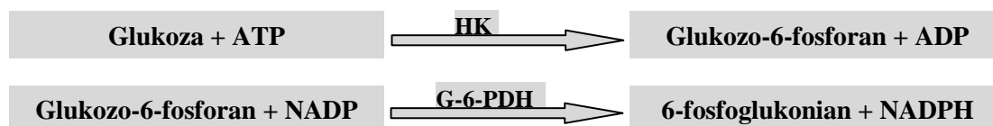
Ryc. 9. Mechanizm reakcji chemicznych w oznaczaniu stężenia glukozy
