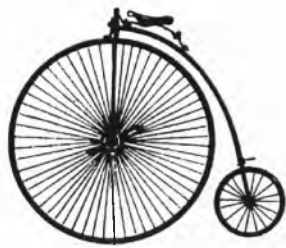
Wyprodukowany w 1883 roku bacykl miał już pełne ogumienie i stopień umożliwiający dostanie się na siodełko.
