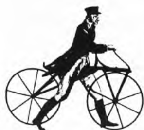
„Dwukolowego konia” skonstruował już pełne ogumienie i stopień umożliwiający dostanie się na siodełko.
