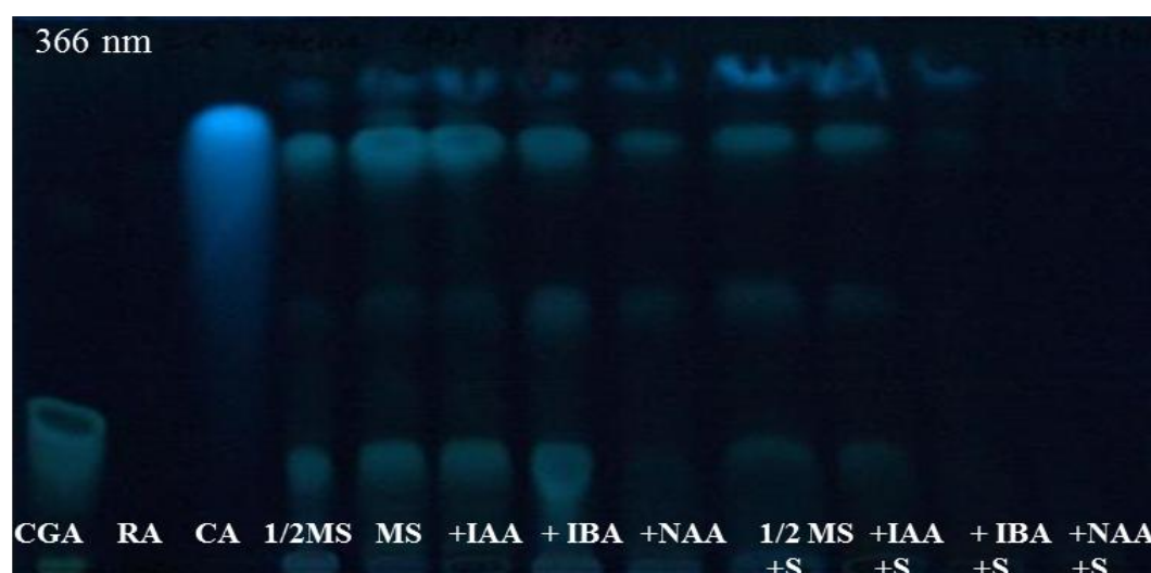
Fot. 47 Chromatogram TLC ekstraków etanolowych z kultur korzeniowych E. campestre – analiza fenolokwasów (faza stacjonarna żel krzemionkowy HPTLC Alufolien Kiesel 60, faza ruchoma OAW 8:1:1, detekcja UV 366 po wywołaniu NA) CGA Kwas chlorogenowy RA Kwas rozmarynowy CA Kwas kawowy
