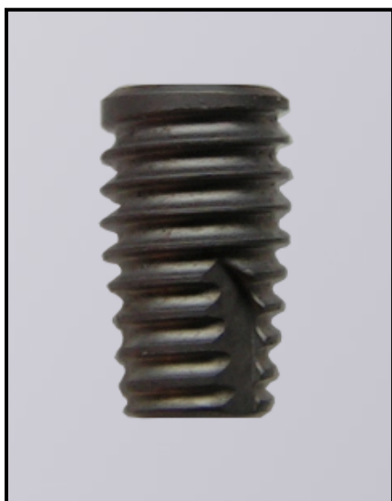
Ryc. 3 Wszczep użyty w badaniu (średnica 4mm, długość 7mm).
