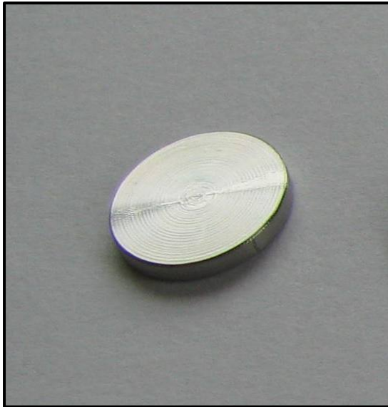
Ryc. 6 Dysk tytanowy zastosowany w badaniu (średnica 8mm, grubość 1mm).
