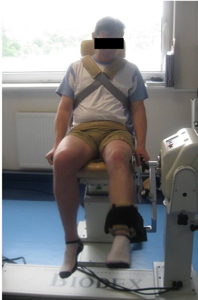
Ryc. 7 Pozycja osoby badanej oraz stabilizacja podczas testu izokinetycznego stawu kolanowego (dwa pasy skrzyżowane na klatce piersiowej, jeden na miednicy i udzie).
