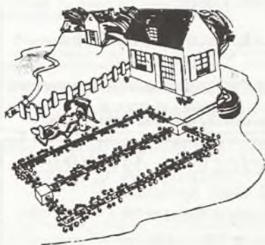
Schemat domowej oczyszczalni ścieków
