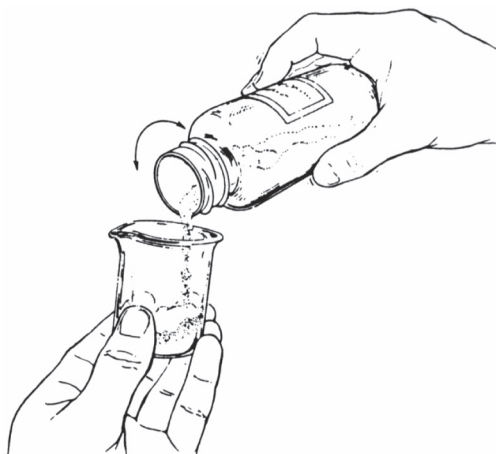
Rys. 27. Obracaj i potrząsaj słoikiem z odczynnikiem, aż pobierzesz potrzebną ilość odczynnika
