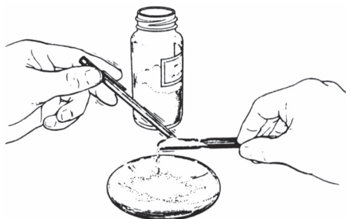
Rys. 26 b. Uderzając w kartonik lub łyżkę pobierz odpowiednią ilość odczynnika
