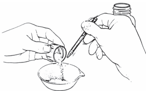
Rys. 25. c. Uderzaj w zakrętkę ołówkiem lub palcem do czasu aż pobierzesz odpowiednią ilość odczynnika
