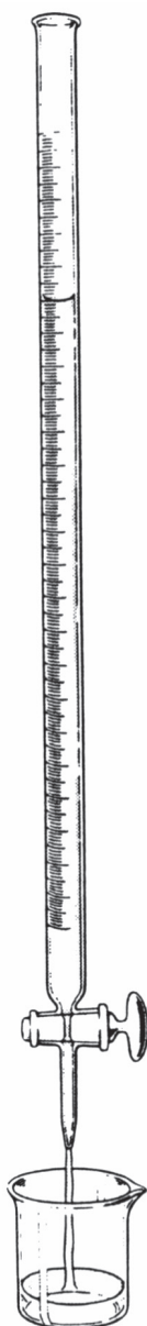
Rys 35. Otwórz kurek w celu usunięcia powietrza z wylotu biurety
