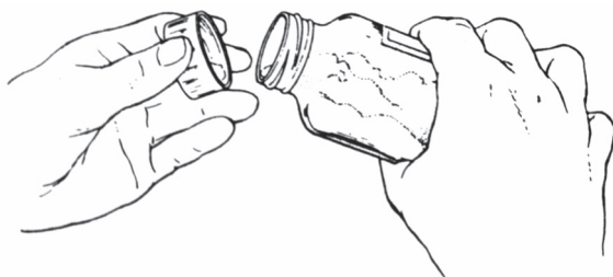
Rys. 25. b. Ostrożnie odkręć zakrętkę tak aby część odczynnika pozostała w niej
