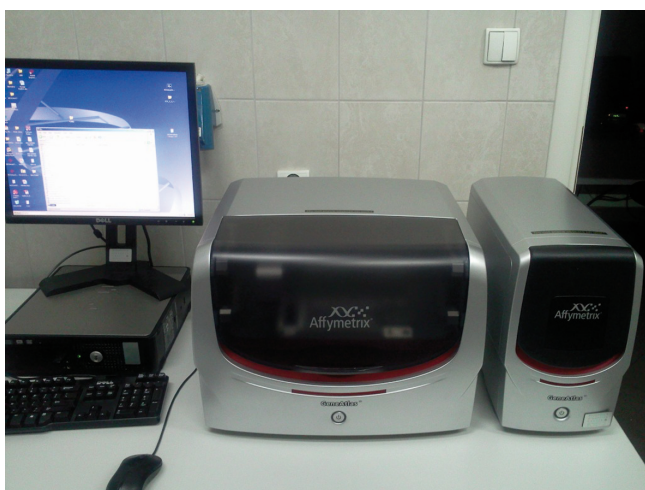
Fot. 7. Blok cieplny AccuBlock oraz zestaw GeneAtlas Personal Microarray System (poniżej) stosowane w badaniach ekspresji genów.
