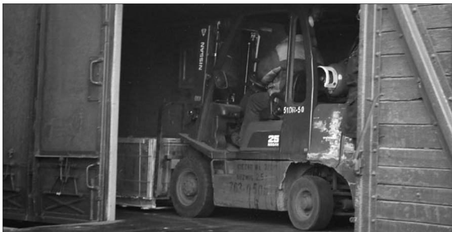
Układanie skrzyń sztaplarką w wagonie wymaga od operatora dużych umiejętności. Nz. Załadunek wagonów na nabrzeżu Wiślane, PG-Eksplotacja.
