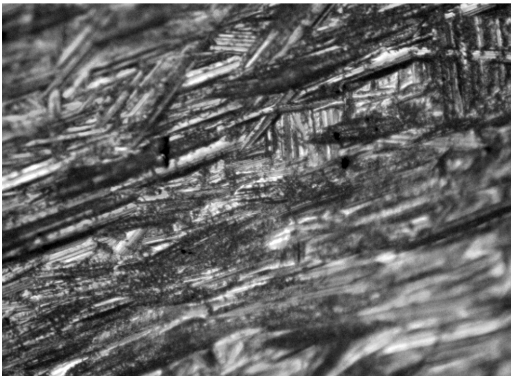
Ryc. 5. Powierzchnia Cerconu po obróbce laboratoryjnej drobnoziarnistym wiertłem diamentowym z chłodzeniem wodnym ( powiększenie x 300).
