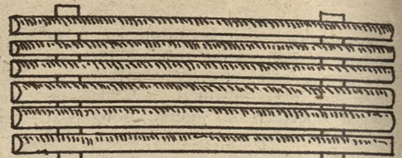
Dno wozu z przepołowionych drągów 8—10 cm.
