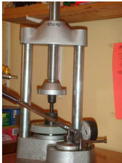
Ryc. 4.4. Schemat prasowania jednoosiowego: jednostronnego
