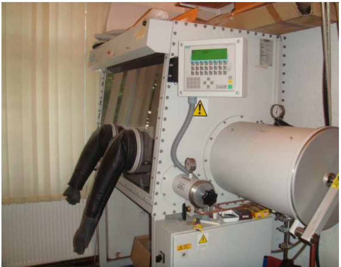
Ryc. 4.2. Komora rękawicowa Labmaster 130 firmy M.Braun
