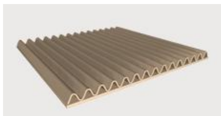
A. tektura dwuwarstwowa - warstwa płaska i pofalowana
