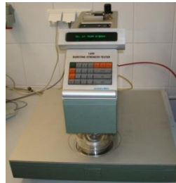
Rys. 42. Aparat do badania wytrzymałości na przepuklenie Źródło: Opracowanie własne
