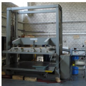
Rys. 40. Prasa z napędem mechanicznym do badania odporności na ściskanie
