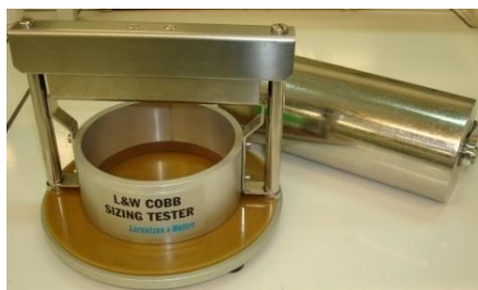
Rys. 43. Aparat Cobb do badania chłonności wody Źródło: Opracowanie własne
