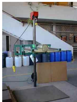
Rys. 41. Zapadnia do badania odporności na spadki
