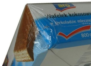
Rys. 64. Znaczne odkształcenie naroża SRP wafelków Aro firmy Mieszko Źródło: Opracowanie własne
