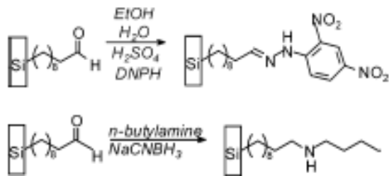
Rysunek 8. Reakcje tworzenia kolejnych warstw na funkcjonalizowanej powierzchni krzemu [28].
