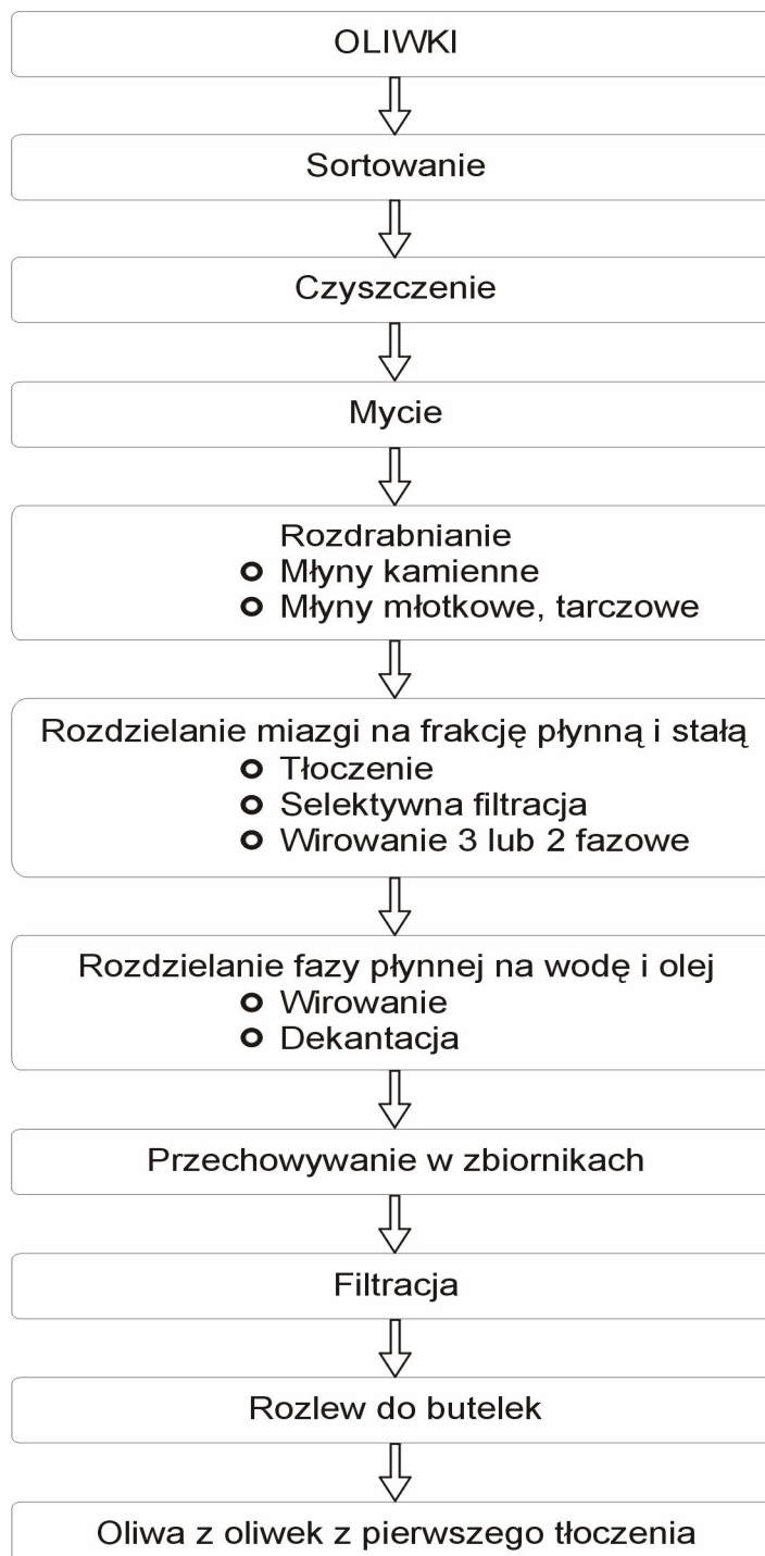
Rys. 2/1. Schemat technologiczny otrzymywania oliwy z oliwek z pierwszego tłoczenia
