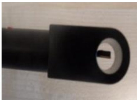
Rycina 25. Sonda do pomiaru funkcji barierowej warstwy rogowej naskórka TEWL MC 750 Courage & Khazaka [opracowanie własne]
