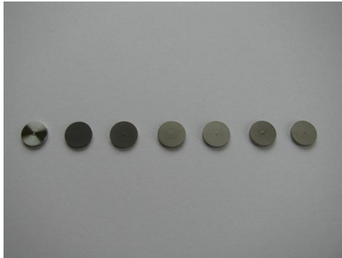
Ryc. 4.2. Materiał badawczy – dyski tytanowe o średnicy 8mm i grubości 1mm
